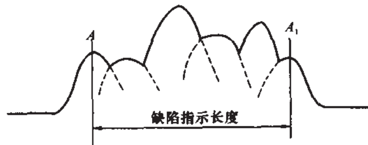
图 7.3.9 端点峰值测长法
